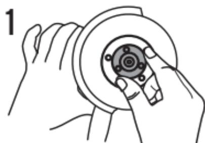
Coloque el adaptador en la flecha de la máquina
